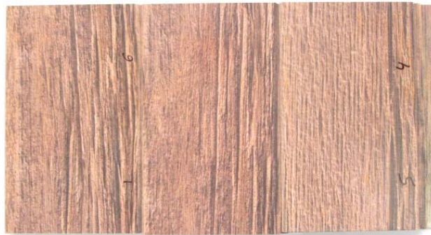
Échantillons: DiZal après le test de graffiti
